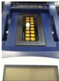
Low profile対応のPCR機器にセットし、PCR反応(約30分)
